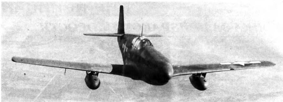
«Мустанг» с мотором «Мерлин» и подвесными баками. При виде спереди хорошо видно, что самолет представлял собой практически мотор с крыльями, аэродинамику которого «портит» лишь слегка выступающая кабина пилота.
