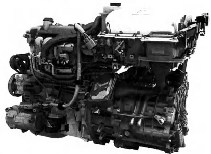
Комбинированный силовой агрегат "Приуса" – двигатель внутреннего сгорания и электродвигатель
